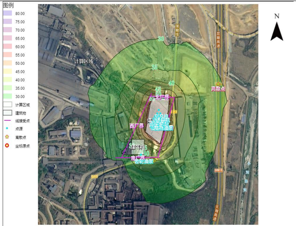
煤气发电噪声预测等值线图
